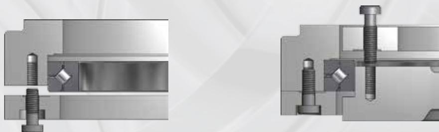
Befestigung von Kreuzrollenlager mit Klemmrings
